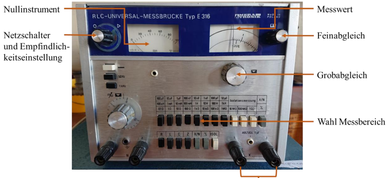
Abbildung 1: RLC-Messbrücke mit Erklärung der Bedienelemente
